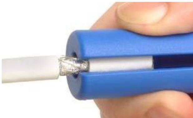
Placer le câble coaxial dans l'outil du côté de la plus petite lame, côté A (lame courte). Si bien que le manteau extérieur puisse être coupé à 10 mm de la coupe du diélectrique (20 millimètres de l'extrémité de l'âme). Fermer l'outil fermement et effectuer une rotation d'¼ de tour à droite puis à gauche et ensuite tirer.
